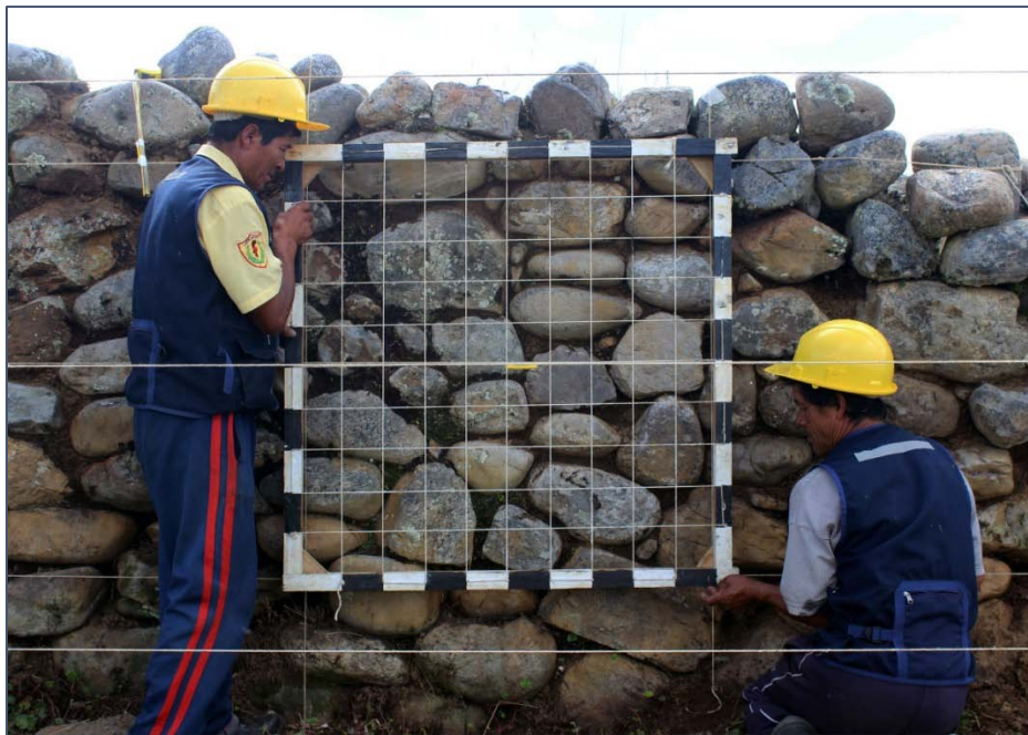
Fig. 02: Proceso de nivelación del paramento y nivelación de la malla cuadriculada cada 10 cm. para la toma fotográfica.
