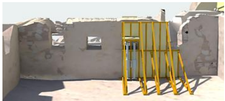
Foto 8: Modelo 3D de la técnica de apuntalamiento
