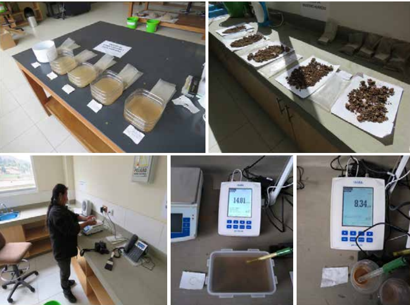
Figura 5. Proceso de análisis de conductividad y Ph de las muestras recogidas en laboratorio.
