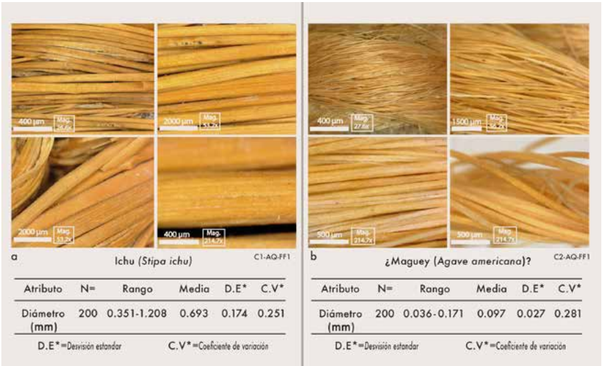
Figura 16. Caracterización de materiales mediante microscopía. Identificación de materia prima y estimación del diámetro para los filamentos de fibras vegetales empleadas en cordería y cestería (fotos por Mirko Brito).
