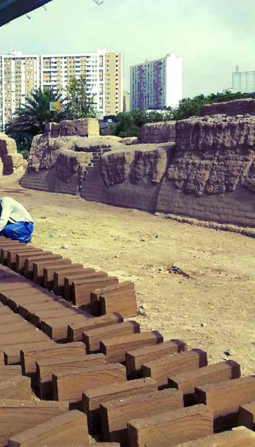
El efecto del dormido y el amasado aumenta alrededor del 10% la resistencia del material debido a que el agua llega a tomar contacto con más partículas de arcilla.
