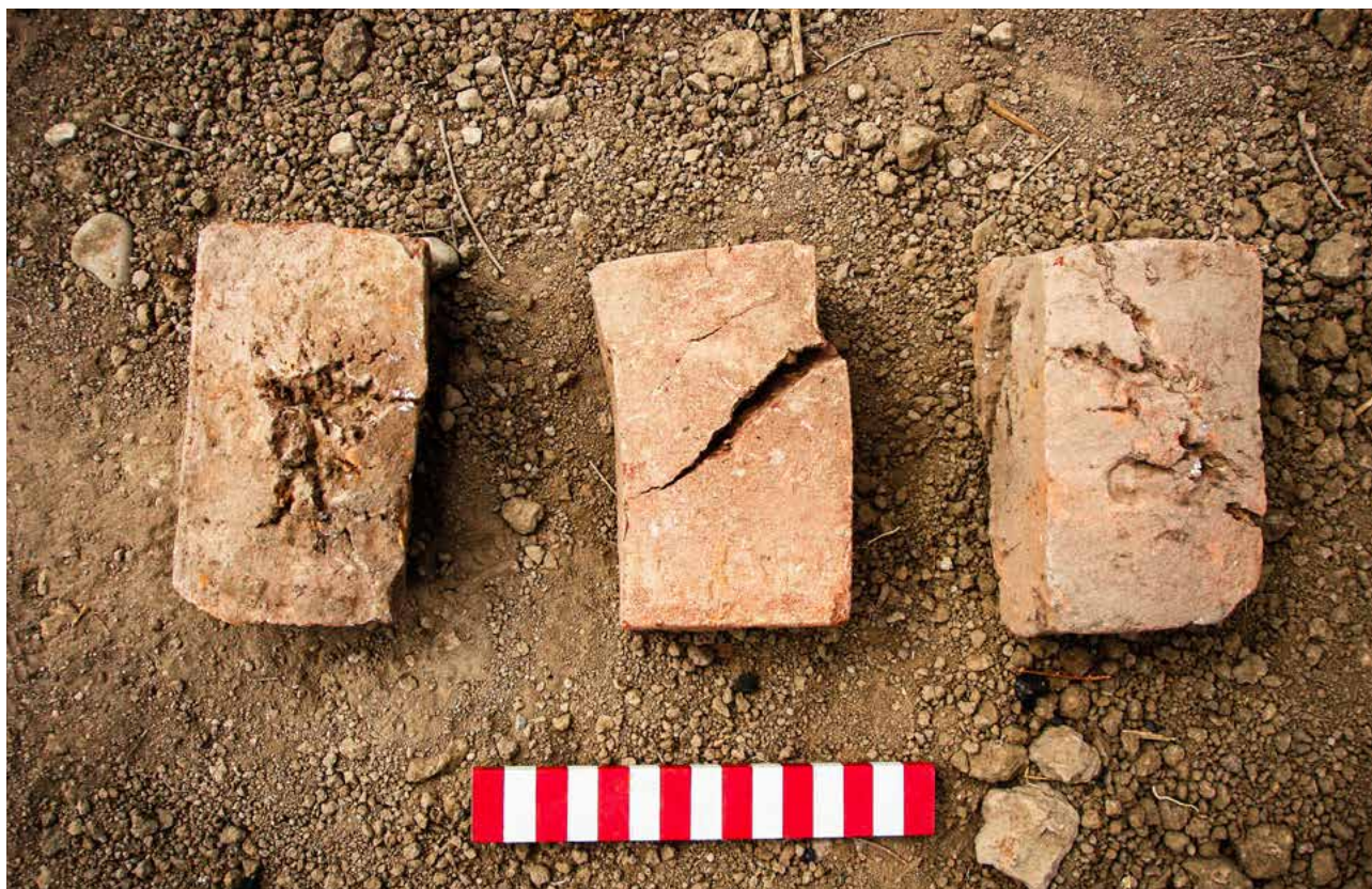
foto 26. Ladrillos resquebrajados por horneado deficiente. Escala: 15 centímetros (Archivo fotográfico del Proyecto Mateo Salado, 2013).
