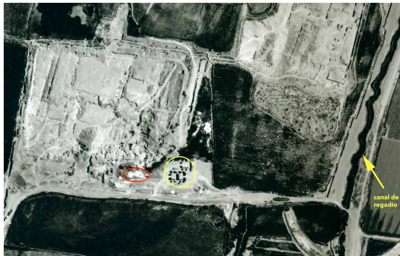
Foto 23. Detalle de una vista aérea de Mateo Salado, en la que se indica la ubicación de los hornos de calcinación (círculo amarillo) y de un empozamiento (elipse naranja) causado por los ladrilleros. Se señala el canal desde el cual se desviaba agua hacia las pirámides (Servicio Aerofotográfico Nacional, 1944).
