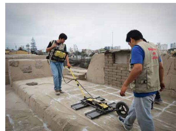
Foto 496. Prospección con georradar en las inmediaciones del Pozo Ceremonial (Archivo fotográfico del Proyecto Mateo Salado, 2015).
